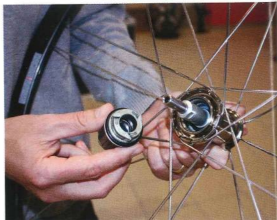
Le moyeu Corima S+ permet un démontage rapide d'un corps de cassette.
